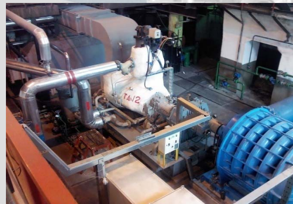
Турбопривод К-1,1-1,6 к нагнетателю воздуха ТП-680 Волгоградский фил. Омсктехуглерод 2012 г.
