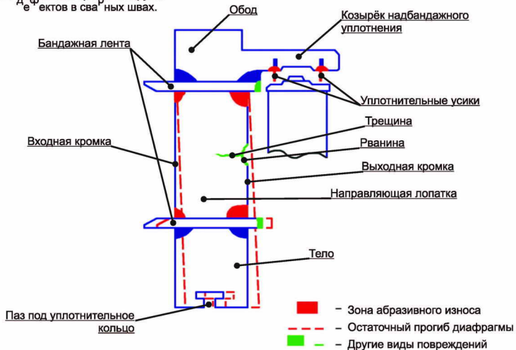
Рис. 1. Схема возможных повреждений в диафрагме.
